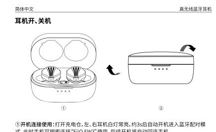
式,此时手机可搜索连接"FiiO FW3"使用,后续开机将自动回连手机。 ②关机充电:将左、右耳机放入充电仓内,合盖后耳机自动关机进充电状态。
