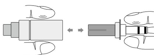
①根据图示箭头指示方向旋转母端，直至母端可被前后推动，即解锁。
