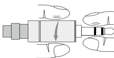
①以母端内部凸点为准星，公端凹槽对准平行插入，直至公端插到位。
