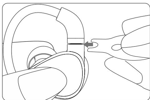
①将辅助器缺口对准耳机线材插头接缝处。
