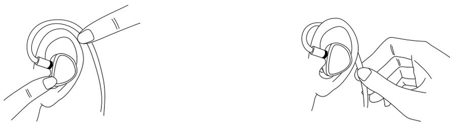
分离耳机线时,紧捏耳机与线材插头,使耳机和线材的插口保持同一直线上,然后用力往两边拔出,或借助MMCX快拆辅助器,详细操作请查阅MMCX快拆辅助器操作指导,0.78双针产品请勿旋转。
