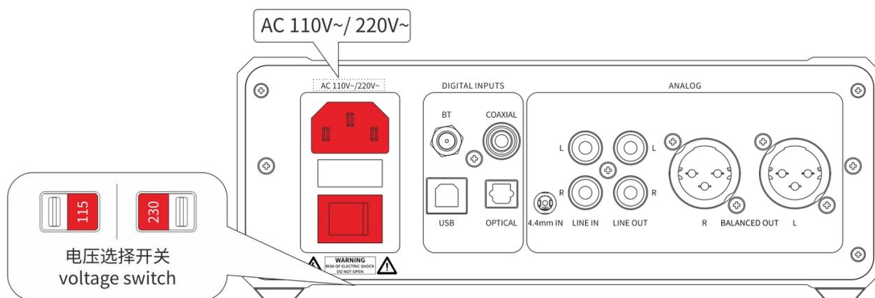
**B 连接输入设备, 选择相应输入源**
