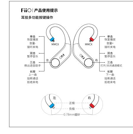
分离耳机线时,紧捏耳机与线材插头,使耳机和线材的插口保持同一直线上,然后用力往两边拔出,0.78双针产品请勿旋转。
