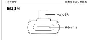
1.通过本产品自带的Type-C接口,可以连接手机、电脑等设备实现 蓝牙LDAC及aptX等蓝牙编码格式的发射。
