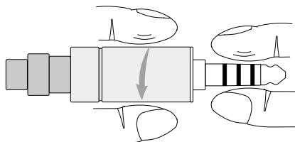
④根据图示箭头指示方向旋转母端，直至拧紧，即锁住。
