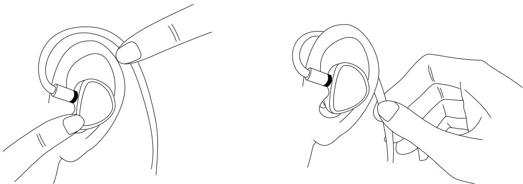
分离耳机线时，紧捏耳机与线材插头，使耳机和线材的插口保持同一直线上，然后用力往两边拔出，或借助MMCX快拆辅助器，详细操作请查阅MMCX快拆辅助器操作指导，0.78双针产品请勿旋转。
