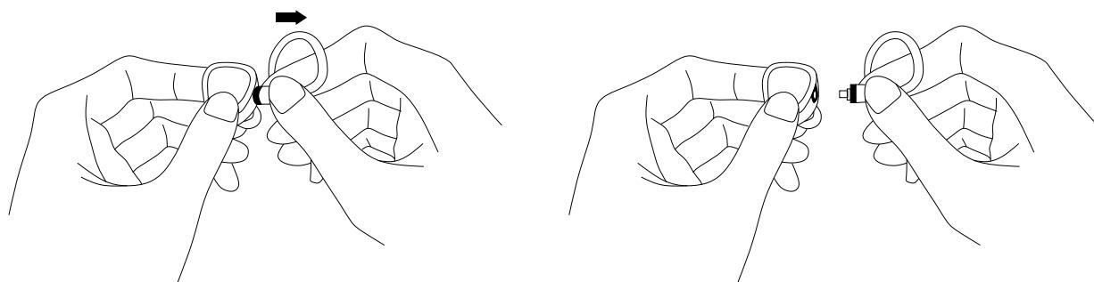
禁止倾斜角度拔插耳机线，请勿直接拉扯线材拔插耳机线，以免线材拉断。
