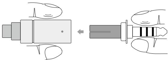
③以母端内部凸点为准星，公端凹槽对准平行插入，直至公端插到位。
