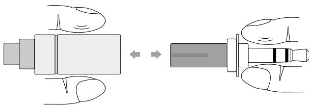
②平行拔出(可借助布条,纸巾等摩擦力大的物体协助)公端，即成功解开。
