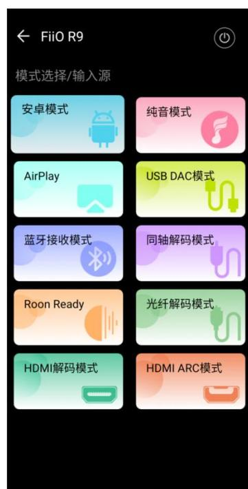
R9 支持安卓模式、纯音模式、蓝牙接收模式、Roon Ready、USB DAC 模式、AirPlay 接收模式、同轴解码模式、光纤解码模式、HDMI 解码模式和 HDMI ARC 模式
