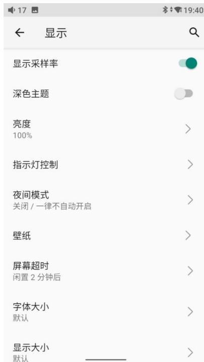
显示设置项包含显示采样率、深色主题、亮度、指示灯控制、夜间模式、壁纸、屏幕超时、自动旋转屏幕、字体大小、显示大小、屏保、锁定屏幕显示，以下选择几个常用功能项展开说明。
